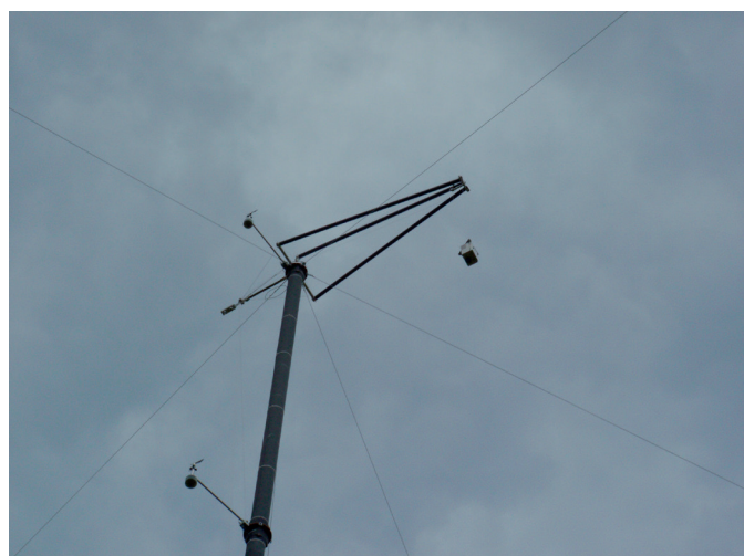
Obr. 3 Poslední sekce stožáru s krakorcem, net-radiometrem, termovizní kamerou v krytu a meteorologickými čidly
