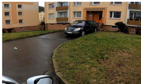
Obrázek 40: Příklad rizikového parkování na nástupních plochách pro požární techniku
